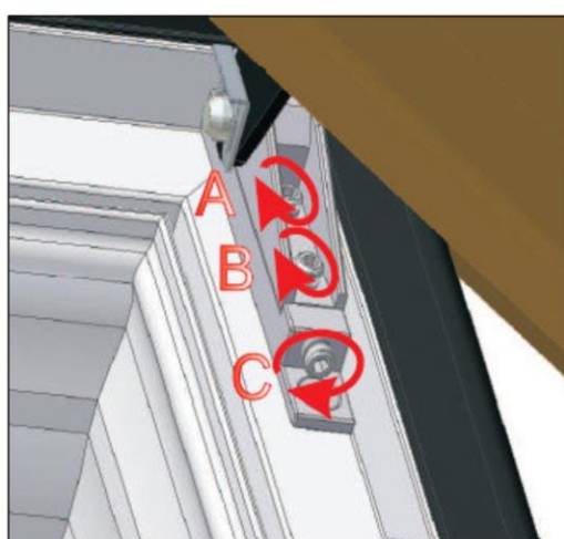
5. Regulace výšky umístění křídla v rámu (jenom servis) A, B - upínací vruty C - regulační vrut
